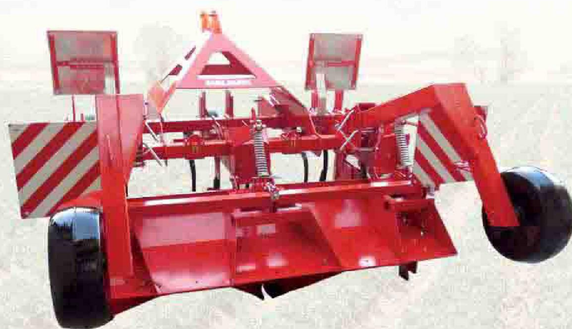
شکل دهی مناسب پشته ها با خاکده شیپری Well shaped with the floating shaping board
